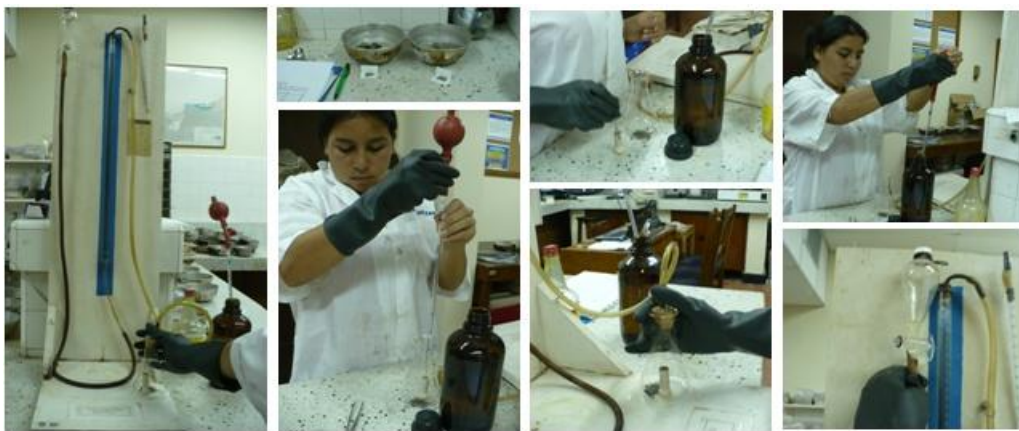
Figura 46: Pasos para determinar el porcentaje de Carbonato de Calcio, secuencia de derecha a izquierda.
