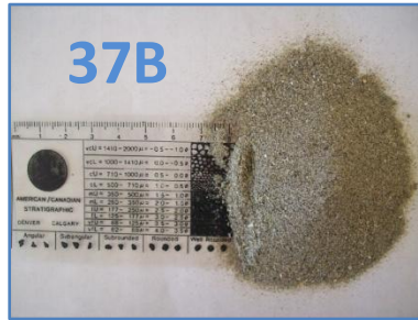
Figura 73: Muestra de núcleo N37B, facie arenas litoclásticas, presenta minerales máficos que le dan una apariencia brillante con pocos restos de conchas ubicada en el extremo entre Bocagrande y El Laguito.
