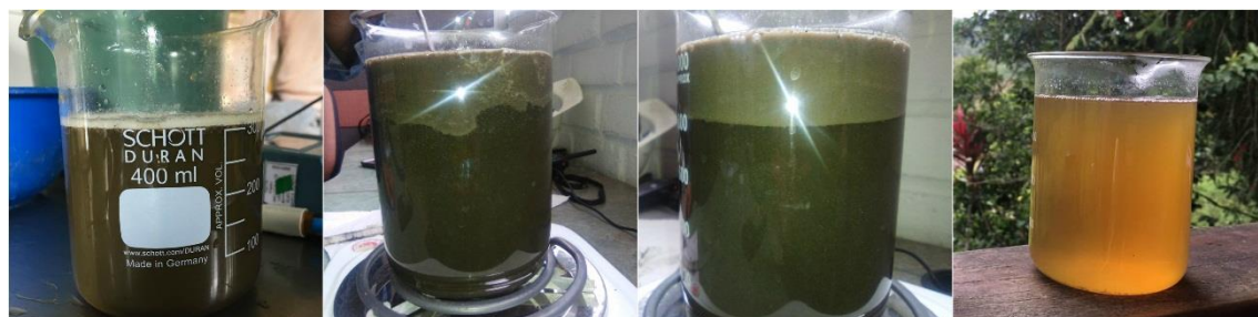
Figura 10. Proceso de limpieza de jugo de caña.
