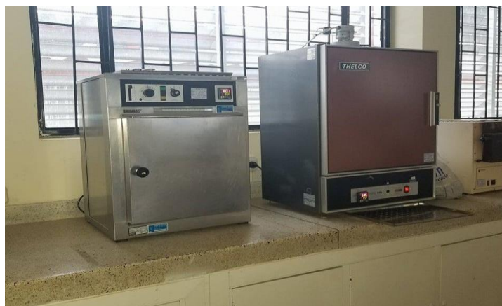
Figura 23. Horno y cámara climática para el control de humedad y temperatura en los ensayos con las muestras de panela en el CIMPA.
