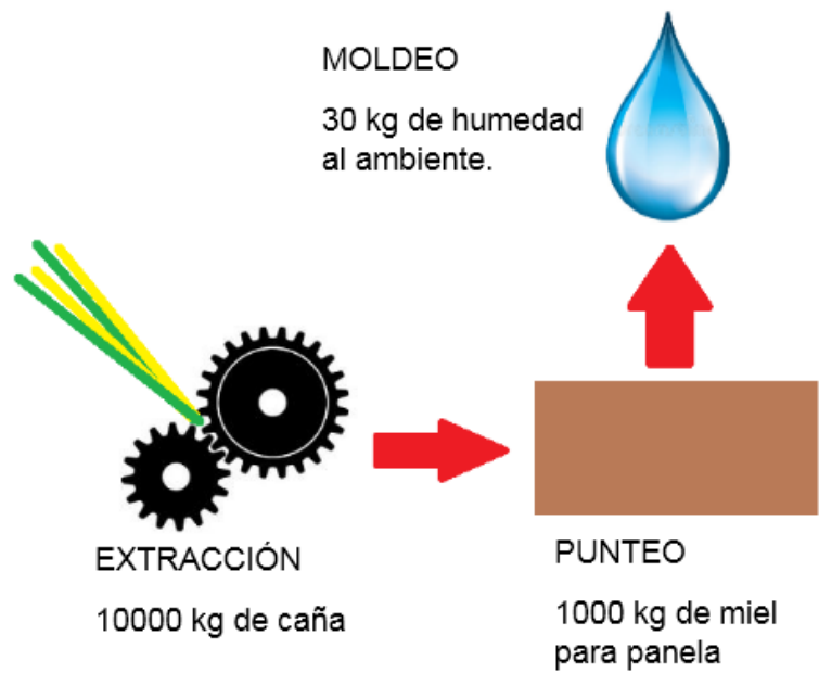
Figura 46. Cantidad de humedad agregada al cuarto por molienda.
