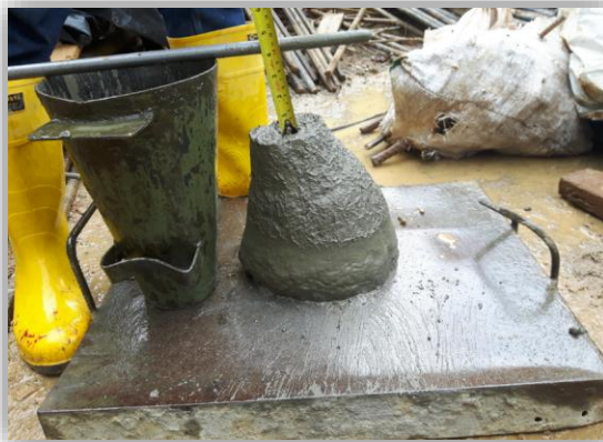
Figura 36. Ensayo determinación de asentamiento
