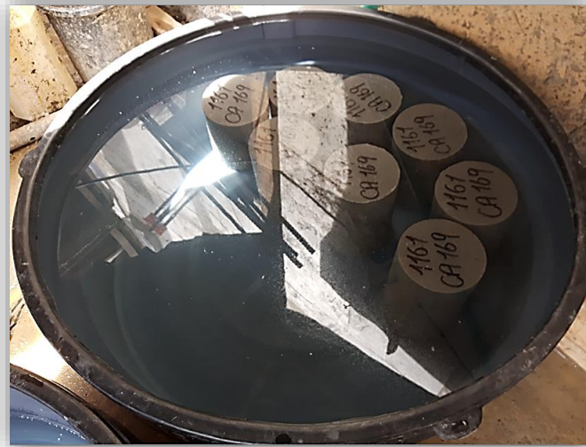
Figura 39. Curado de cilindros en obra
