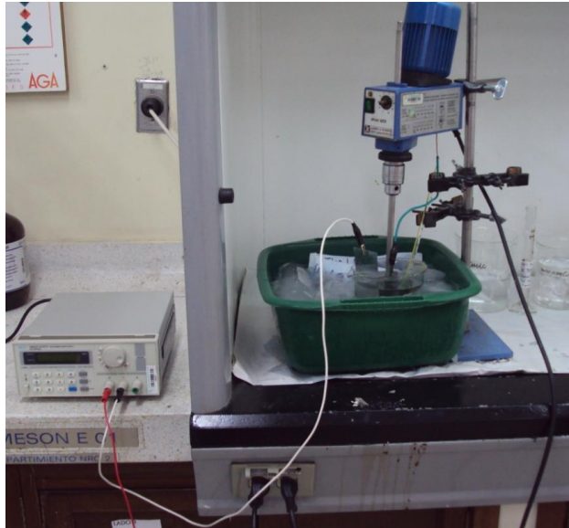
Figura 12. Fotografía del celda electroquímica para la realización del electropulido del aluminio de alta pureza a 20 Voltios por 180s.
