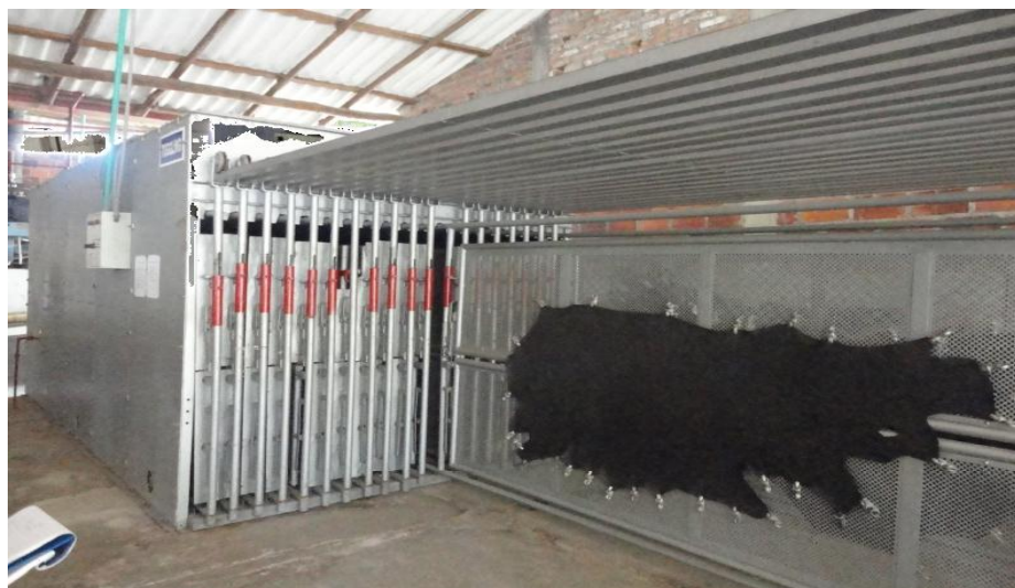
Figura 12. Operación de secado con flujo de aire precalentado
