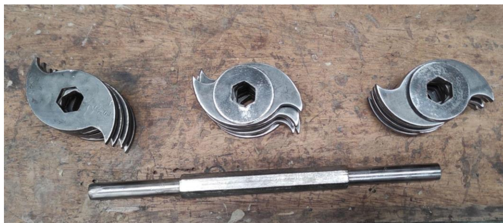
Figura 49. Eje y cuchillas trituradora.
