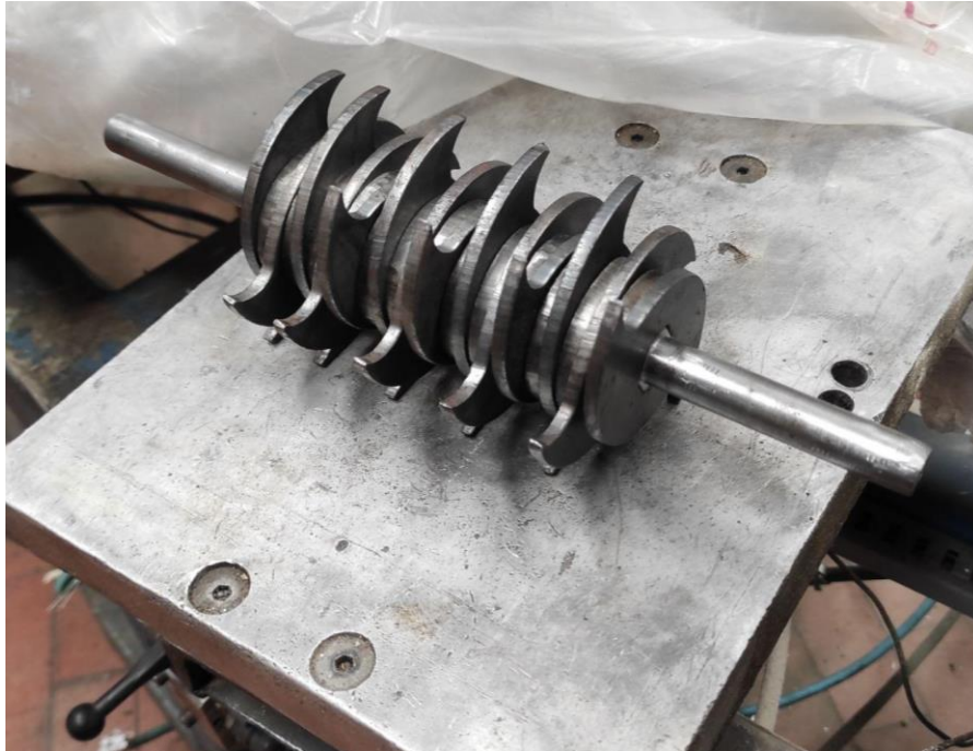
Figura 50. Ensamble de cuchillas con el eje.
