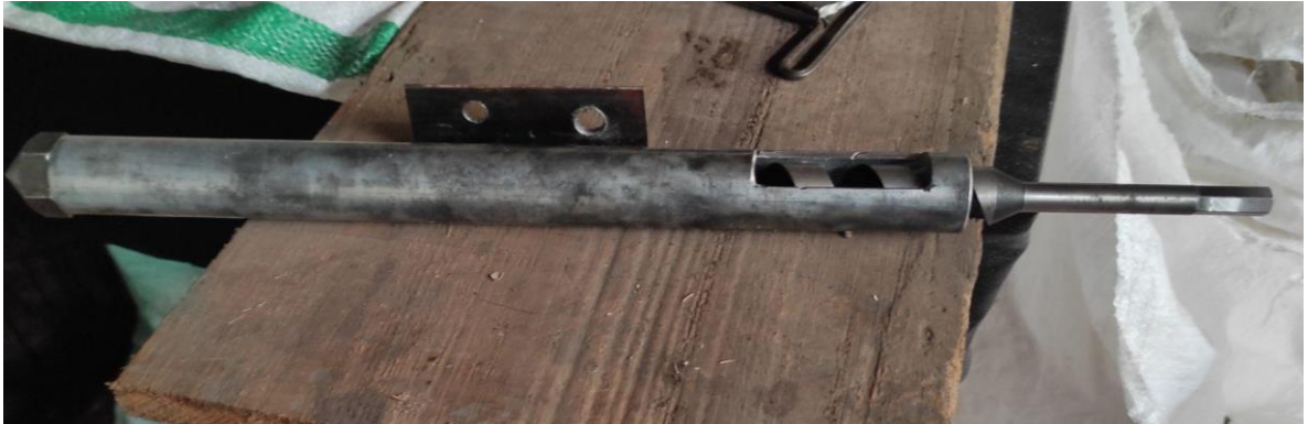
Figura 58. Tornillo extrusor con camisa.
