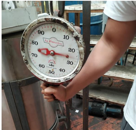
Figura 25. Prueba torque manivela.
