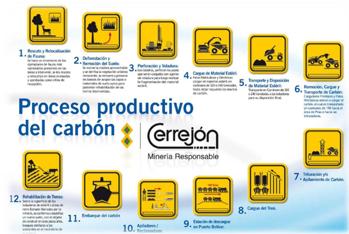
Figura 2. Esquema de proceso productivo del carbón
