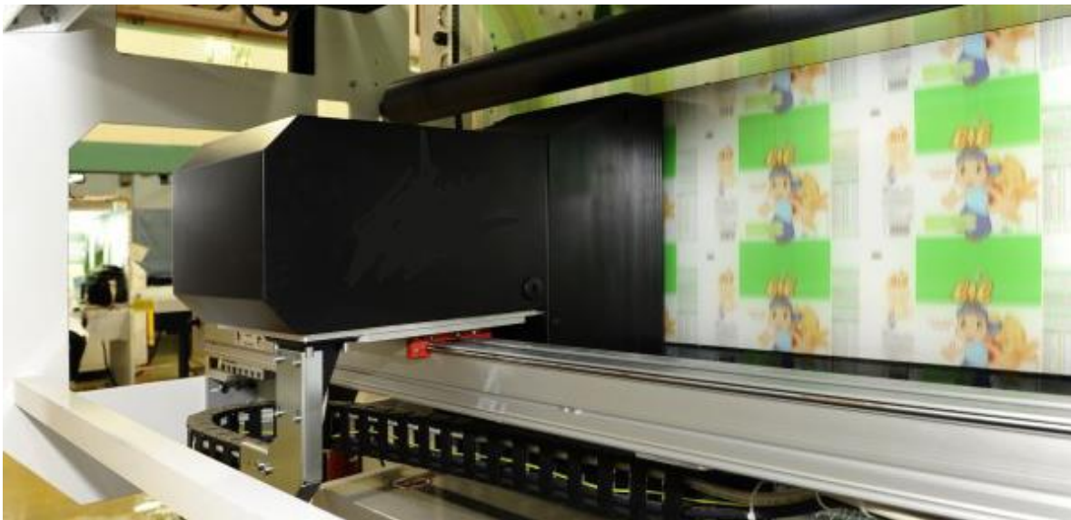
Figura 18. Cámara para detectar defectos.
