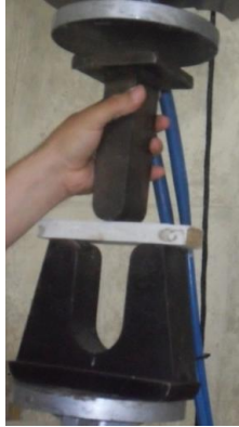
Fotografía 20: probeta lista para ensayo a flexión
