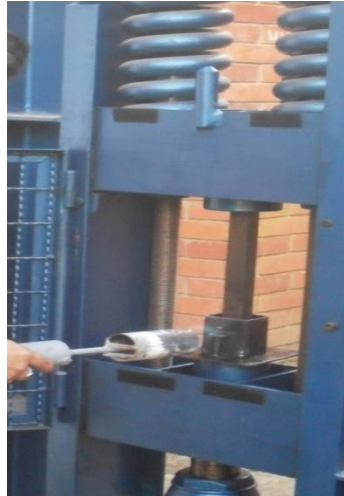
Fotografía 14: temperatura + presión aplicada a la probeta
