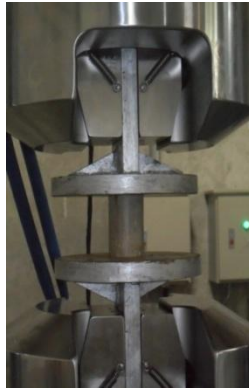
Fotografía 17: probeta lista para ser sometida al ensayo de compresión
