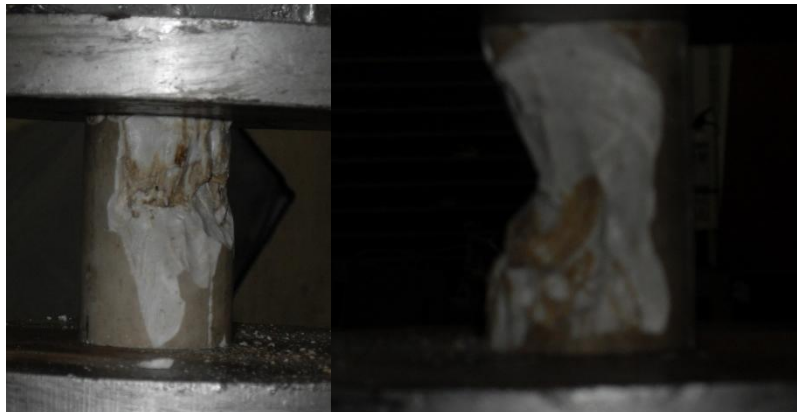
Fotografía 18: Muestras fracturadas obtenidas en ensayo de compresión.
