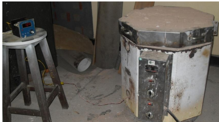
Fotografía 12: termocupla para controlar la temperatura en el horno
