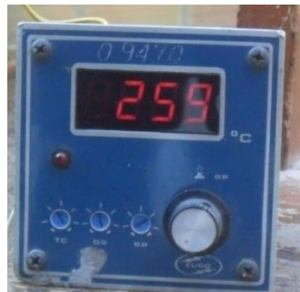
Fotografía 15: termocupla para controlar la temperatura en el molde
