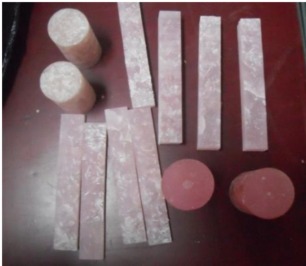
Fotografía 22: probetas de resina poliéster con Pet
