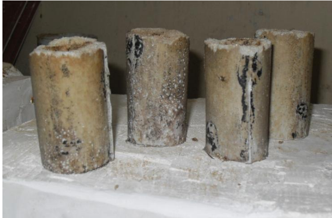
Fotografía 6: primera probetas elaboradas para ensayo a compresión
