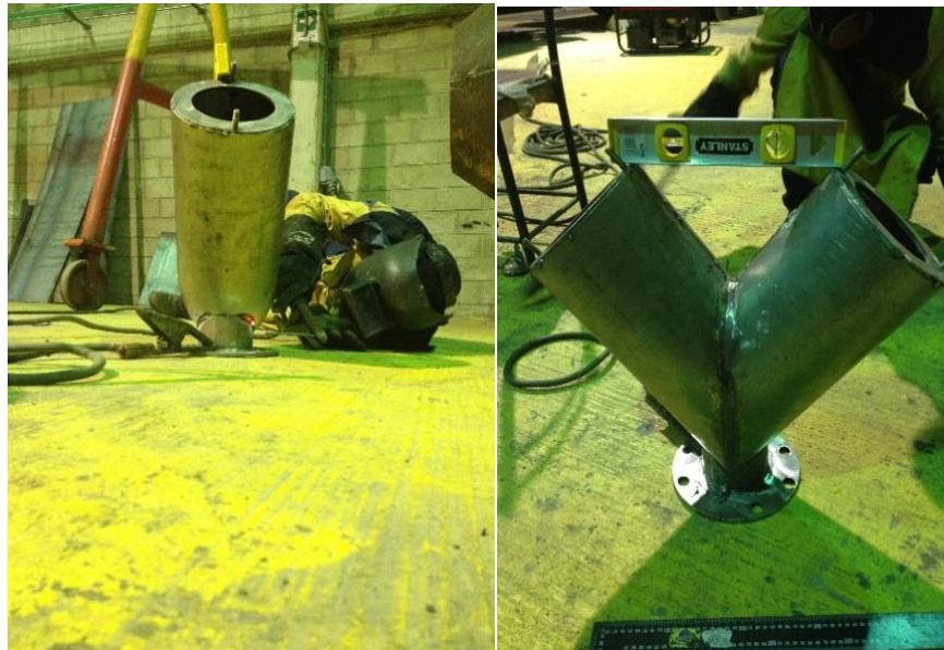
Figura 51. Fabricación cuerpo en V
