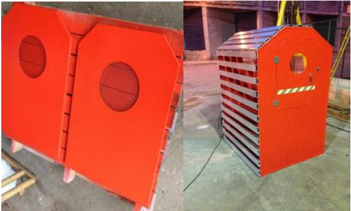
Figura 54. Fabricación cabina de protección
