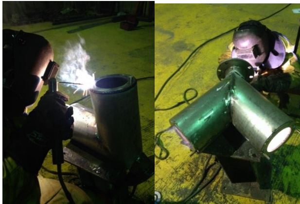
Figura 52. Proceso soldado contenedor
