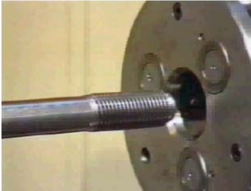
Figura 48. Roscado exterior con terraja
