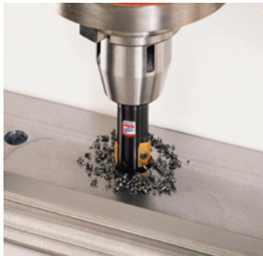
Figura 32. Taladrado con la fresa.
