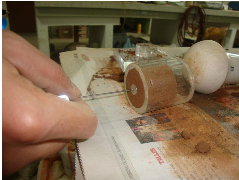
Figura 16. Perforación del espécimen
