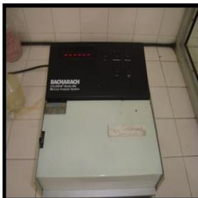
Permite el análisis de mercurio usando como reactivos ácido nítrico, ácido sulfúrico en la presencia de permanganato de potasio que permiten la conversión de todo el mercurio presente a mercurio iónico  $Hg^{++}$ ; Algunos excesos oxidantes son destruidos con cloruro de hidroxilamonio y con la adición de cloruro estañoso se reduce el mercurio  $Hg^{+2}$  a mercurio metálico. Este mercurio formado se lleva a cabo por Adsorción atómica de evaporación en frio a 253.7 nm de radiación emitida.
