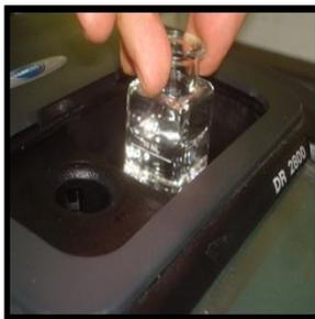
Como patrón de medida se utiliza el hexacloro platinato de potasio con trazas de cloruro de cobalto para reproducir el color natural del agua.
