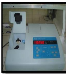
Mide a través de un registro eléctrico la dispersión de la luz a 90°, utilizando el método nefelométrico como medida de turbiedad.
