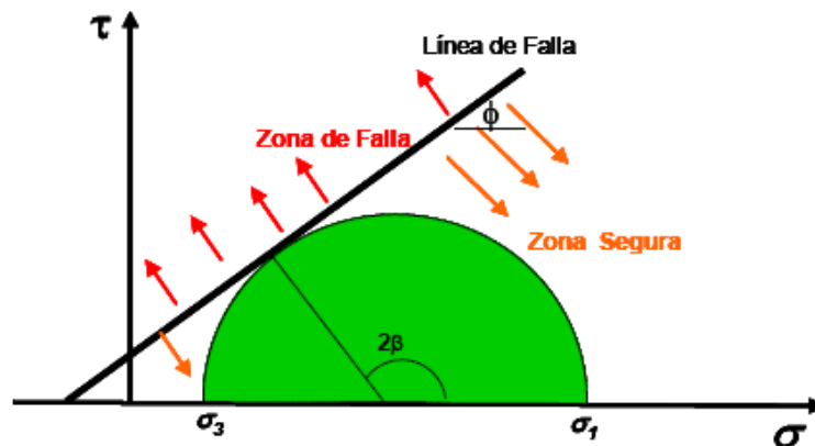
Figura 19. Criterio de Mohr-Coulomb en el plano de los esfuerzos de corte y normal.
