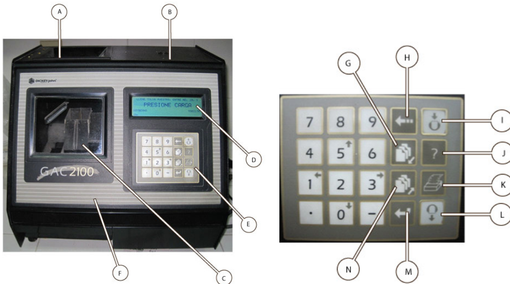
Figura 7. Partes del equipo: Determinador de humedad de Grano
