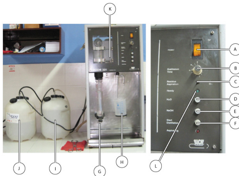
Figura 8. Partes del equipo: Destilador de Proteínas
