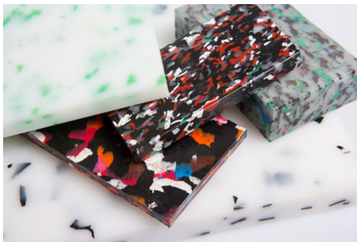
Figura 10. Tablero de PE reciclado
