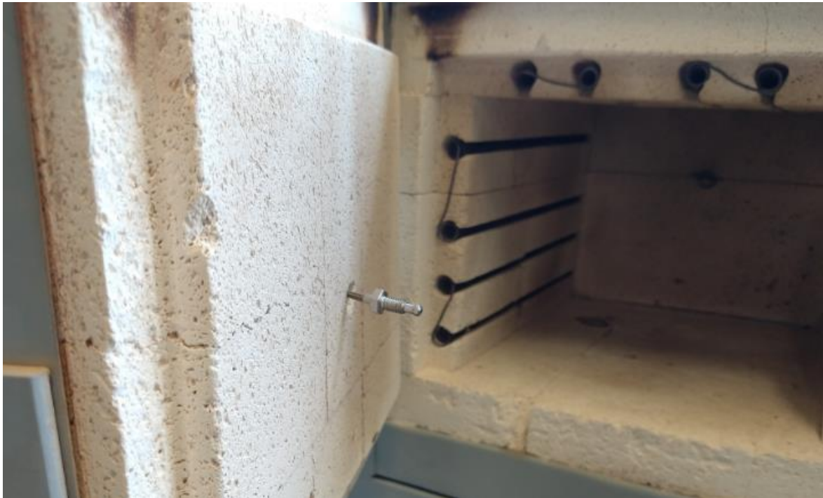
FIGURA 55.POSICIONAMIENTO DE LA TERMOCUPLA EN LA MUFLA.
