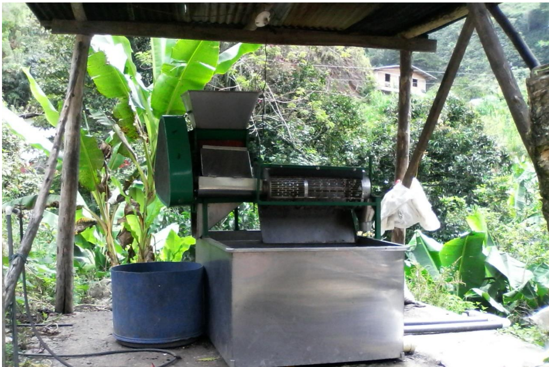
Fotografía 6. Trilladora habilitada en el proceso del café
