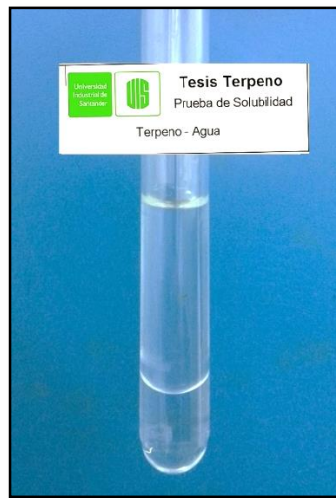
Figura.13: Resultado prueba de solubilidad terpeno-agua.
