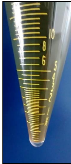
Figura.17: Tubo zanahoria prueba porcentaje BS&W del crudo CPS XL5.
