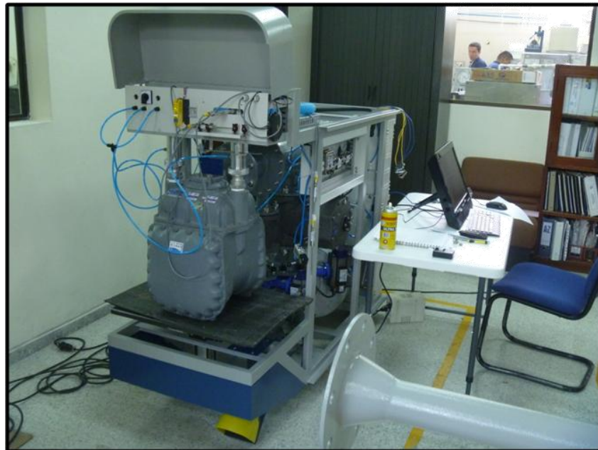
Figura 52. Realización de la prueba de fugas.
