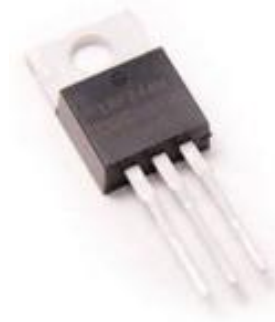
Figura 13 Fotografía del MOSFET utilizado: [13]
