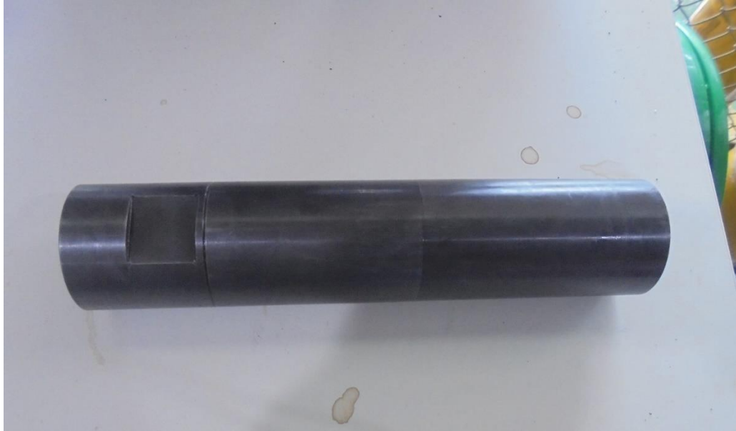
Figura 34. Caja antibloqueo de gas de válvula viajera.
