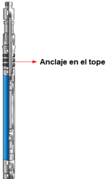
Figura 23. Bomba con Anclaje Superior.
