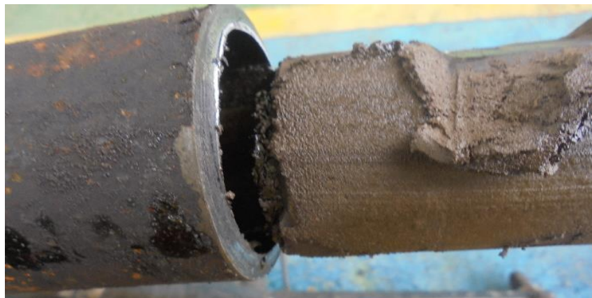
Figura 48. Registro fotográfico del arenamiento de la bomba.
