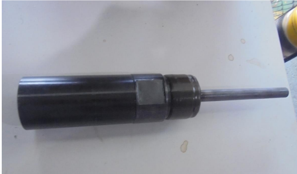
Figura 37. Caja antibloqueo de válvula Fija.
