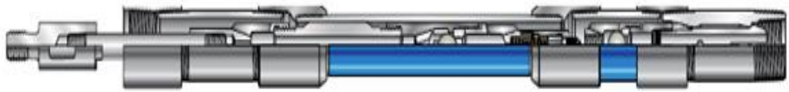
Figura 20. Bomba de Tubería (TH).
