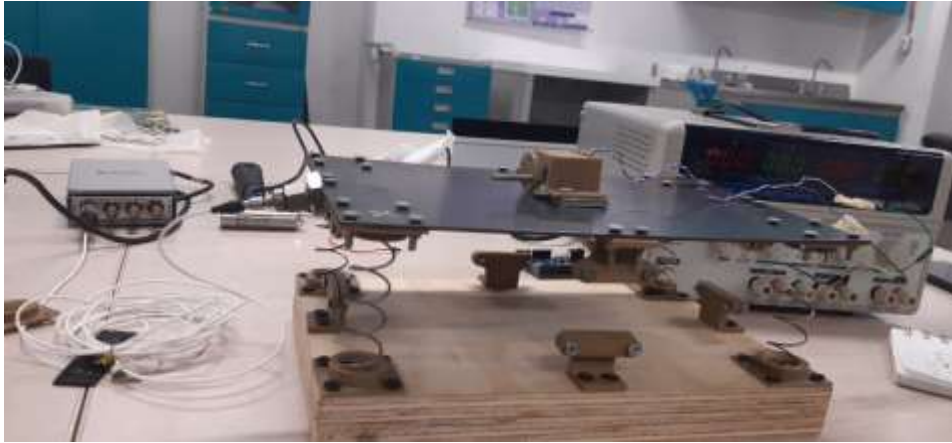
Figura 31. Análisis de vibraciones del Banco sin amortiguamiento
