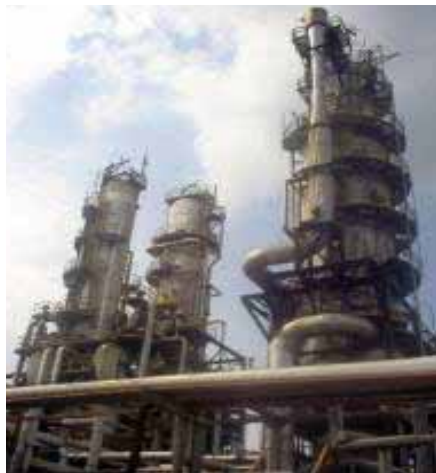
Figura 4. Torres de Destilación de U-200 (de izq. a derecha T-201, T-204 y T-205)
