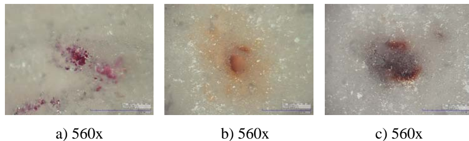
Figura 14. Impurezas encontradas en la superficie de las muestras sinterizadas 1
