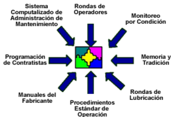
Figura 4. Fuente del mantenimiento preventivo
