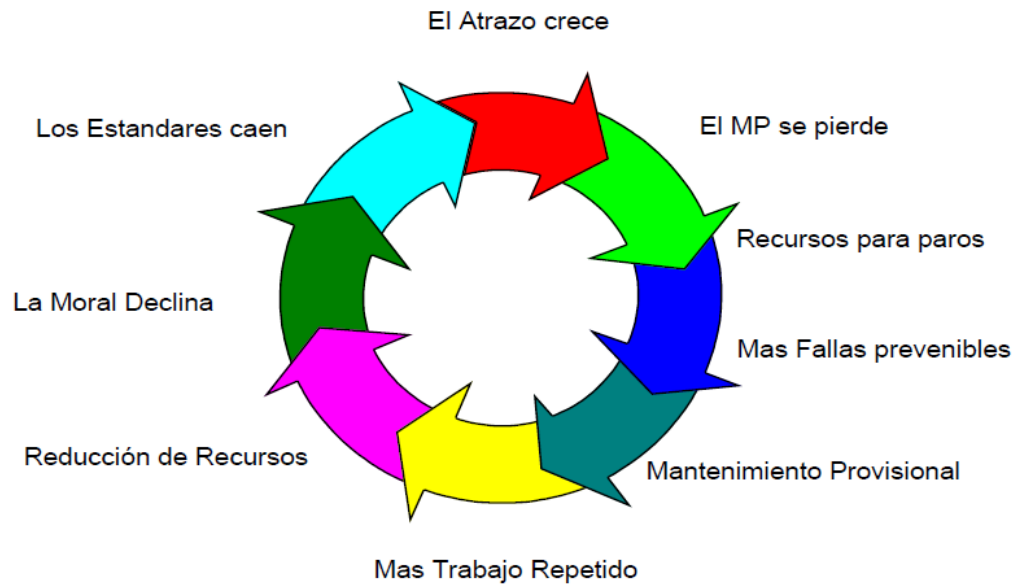
Figura 3. Análisis ciclo reactivo del mantenimiento
