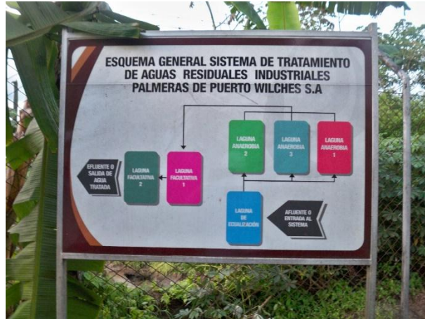
Figura 20. Esquema general de tratamiento de aguas residuales
