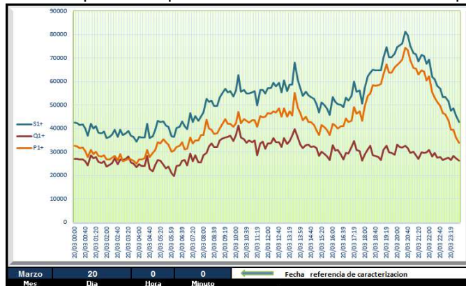
Figura 35: Componentes de la potencia aparente fundamental de secuencia positiva S1+, P1+ y Q1+
