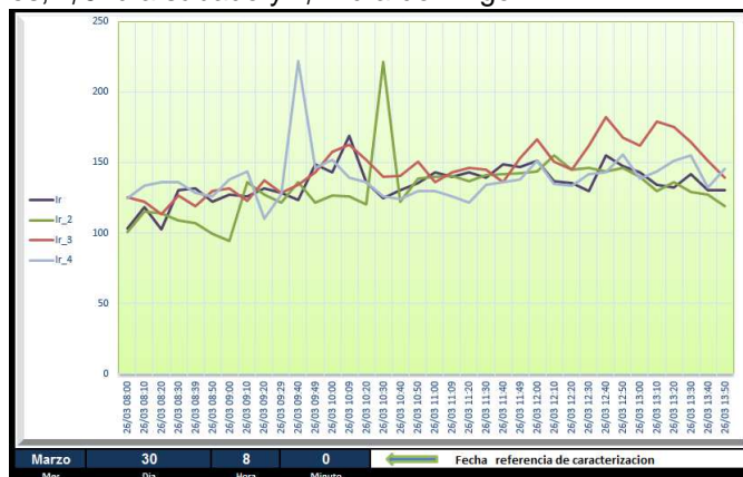
Figura 21: Corriente de dos días entre semana y el fin de semana en una ventana de 6 horas. Ir: día martes, I_{r,2} : día viernes, I_{r,3} : día sábado y I_{r,4} : día domingo
