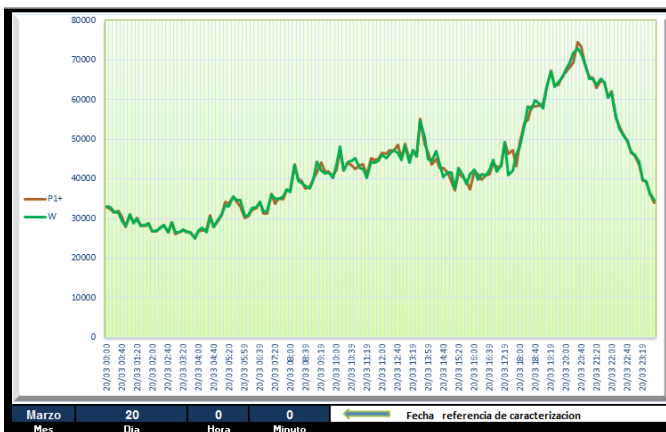
Figura 53: Comparación de potencia activa (P) contra potencia activa fundamental de secuencia positiva (P1+) durante un día
