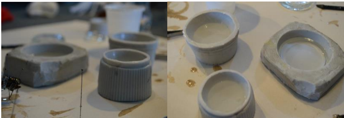
Figura 38. Foto de los moldes en silicona realizados para los encapsulados.
