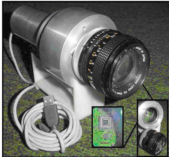
Figura 27 El sensor estelar R 2 D 2
