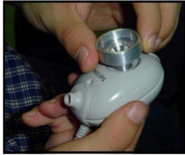
Figura 30 Anillo de acople para lentes tipo C
