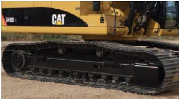
**Opciones de tren de rodaje.** La cadena con dos pasadores de retención firme (PPR2) y ruedas guía fundidas están disponibles como accesorios en la 345D L. La cadena PPR2 evita que se afloje el pasador de cadena del eslabón, y la rueda guía fundida está diseñada para tener una vida útil prolongada. Ambas opciones son ideales para aplicaciones extremas o para aquellas que requieren una gran cantidad de desplazamiento.
