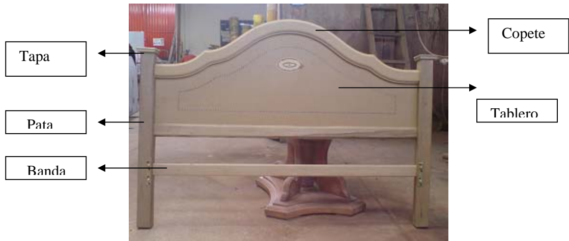
Figura 24. Cabecero de cama romana con sus partes.
