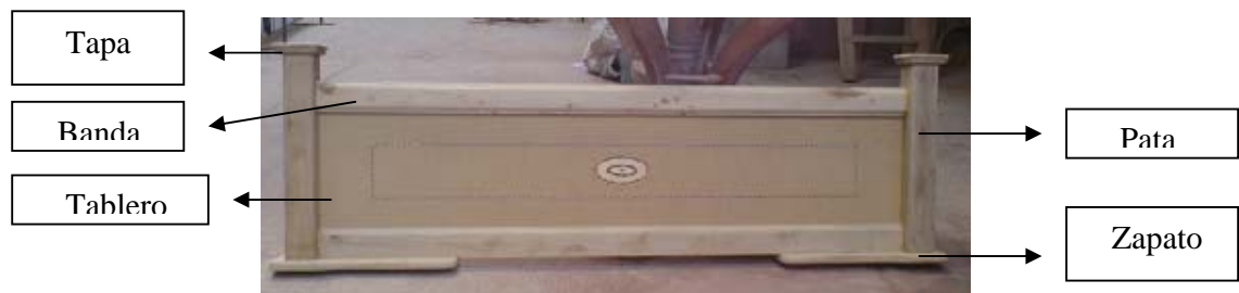
Figura 25. Piecero de cama romana con sus partes.
