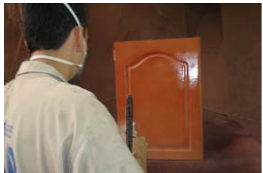
Figura 16. Aplicación de sellador.
