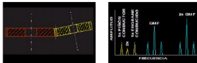
Figura 27. Espectro característico para desalineación entre engranajes.
