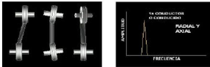
Figura 30. Espectro característico por desalineamiento de poleas.
