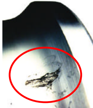
Figura 143 – Falla en un rodamiento.
