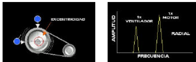
Figura 11. Espectro característico rotor excéntrico.
