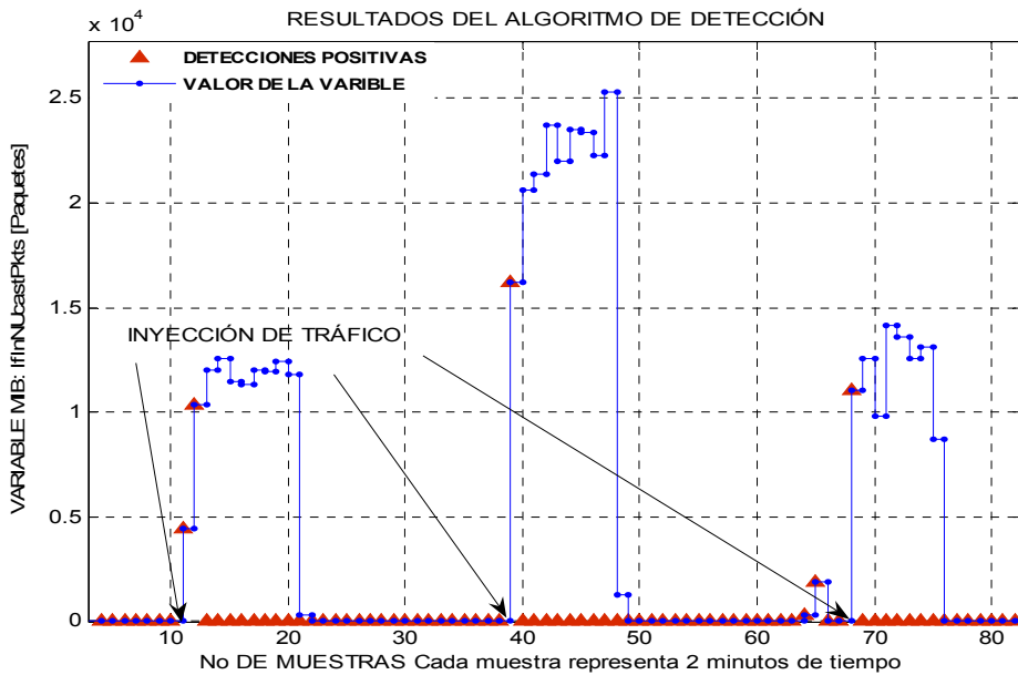
Figura 23. Comportamiento estadístico de la variable IfInNUcastPkts y puntos de detección de anomalías obtenidos con el detector N° 1 para 2.5 horas de monitorización.
