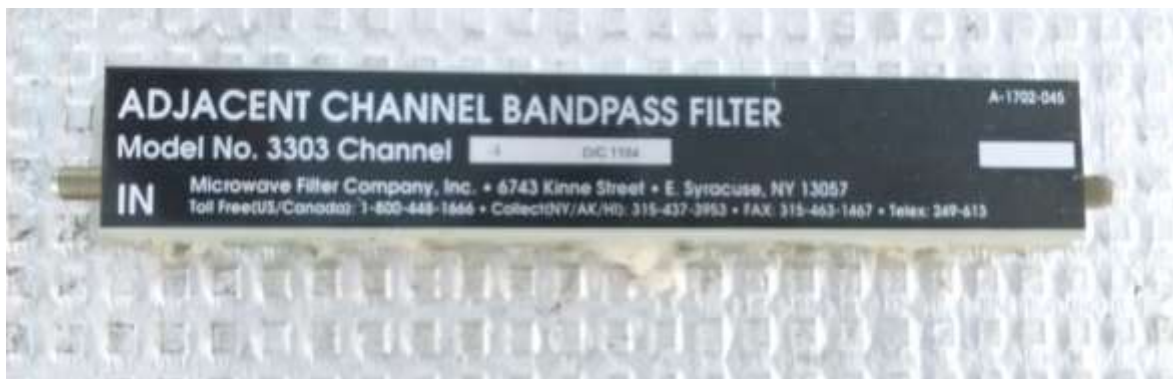
Figura 6. Filtro Pasa-Banda para canal 3 de TV-VHF, entre 60-66 MHz
