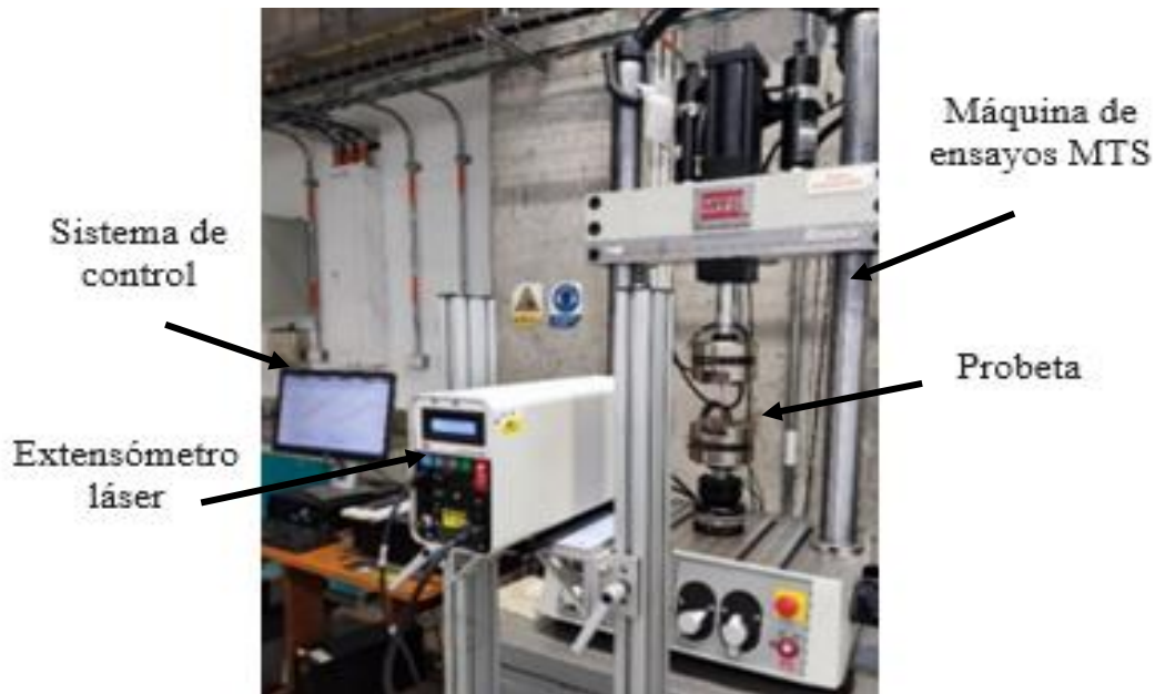
Montaje de ensayo de tracción
