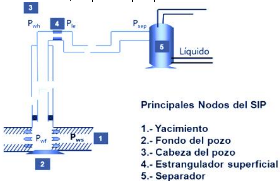
Figura 1 Análisis nodal, componentes principales
