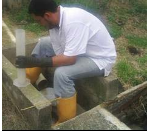
Figura 35. Toma de lectura de IN SITU de (ph, Temperatura del agua y temperatura del agua Ambiental, y caudal)
