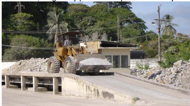
Fotografía 2 Báscula camionera, cargador y patio de acopio de caliza rajón
