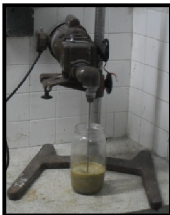
Figura 7. Reactor batch agitado mecánicamente, laboratorio de procesos de Ing. química.
