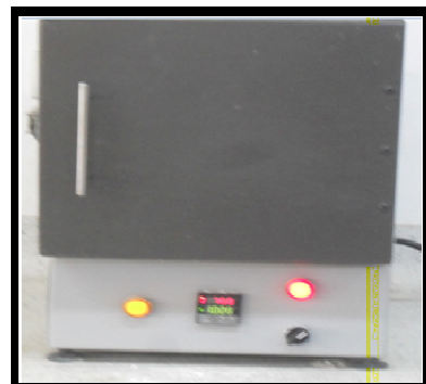
Figura 6. Mufla laboratorio Ing. química
