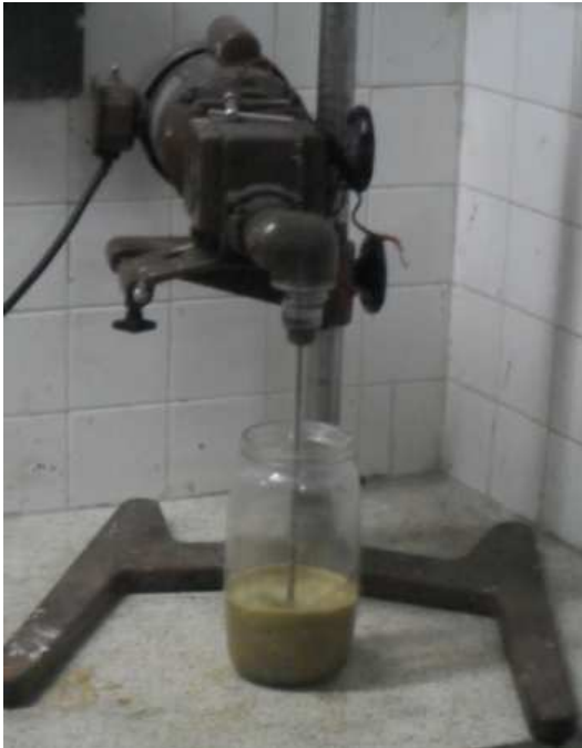
Figura I.5. Agitador mecánico (Laboratorio de Ing. Química UIS)
