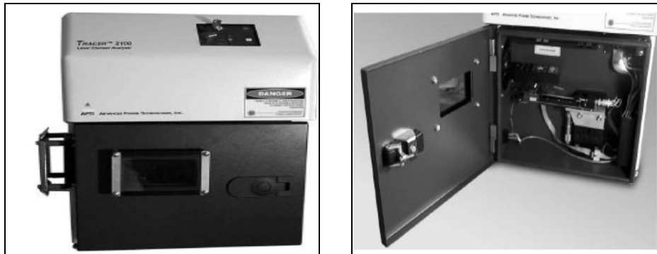
Figura 11. TRACERTM2100 y la cámara donde se muestra el posicionamiento automático multi-muestras.
