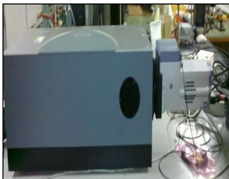
Figura 19. Espectrógrafo Shamrock 500i acoplado a un detector ICCD.
