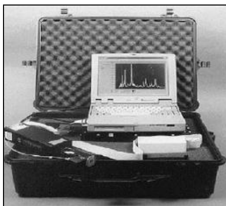
Figura 10. Instrumento portátil LIPS desarrollado para aplicaciones in-situ .
