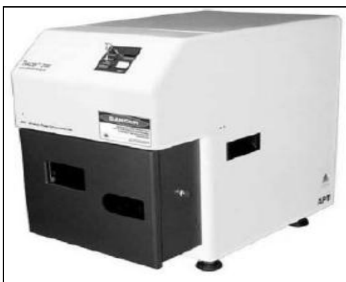
Figura 9. Instrumento portátil LIPS (Tracer 2100) desarrollado por Advanced Power Technologies Inc.
