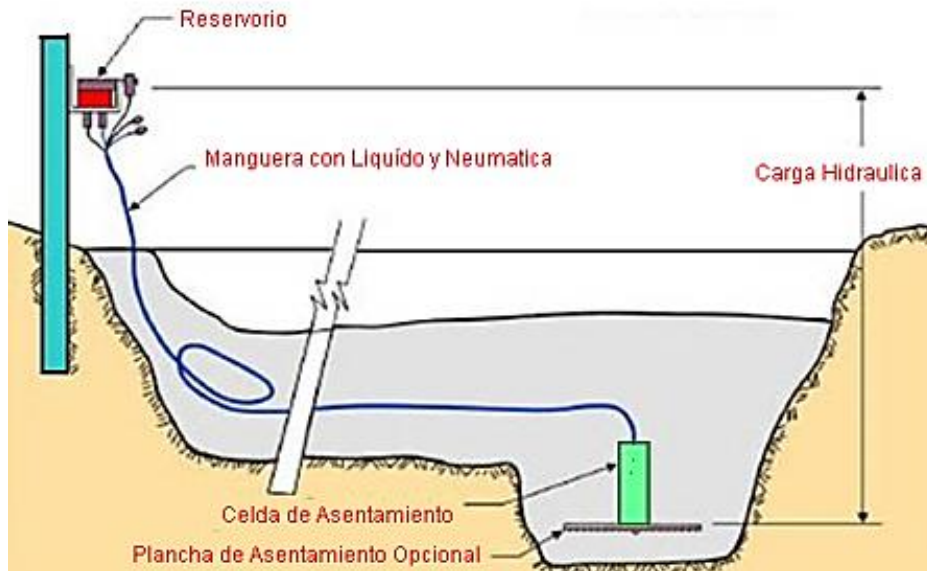
Esquema de funcionamiento de las celdas de asentamiento.
