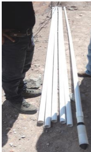
Piezómetro de tubo abierto.
