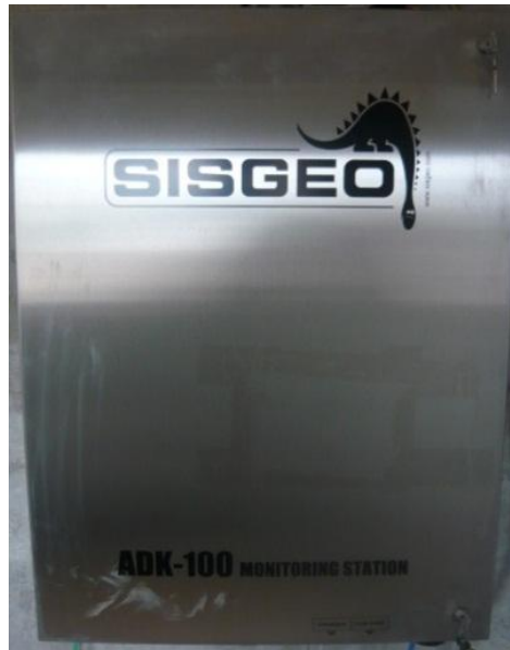
FIGURA 18. Exterior del Armario de adquisición de datos ADK-100.
