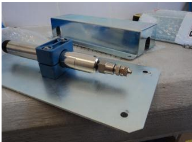
Celda de asentamiento.
