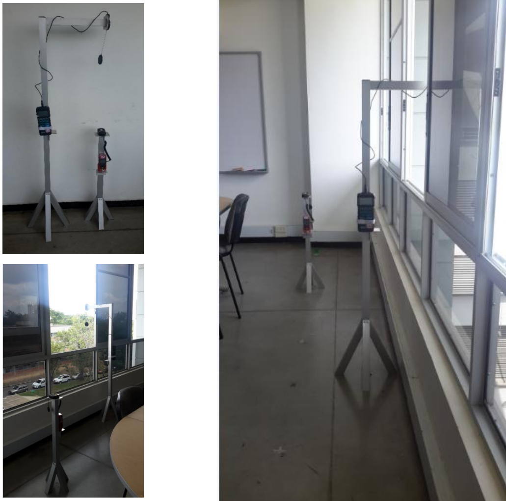
Figura 19. Equipos de medición de iluminancia.
