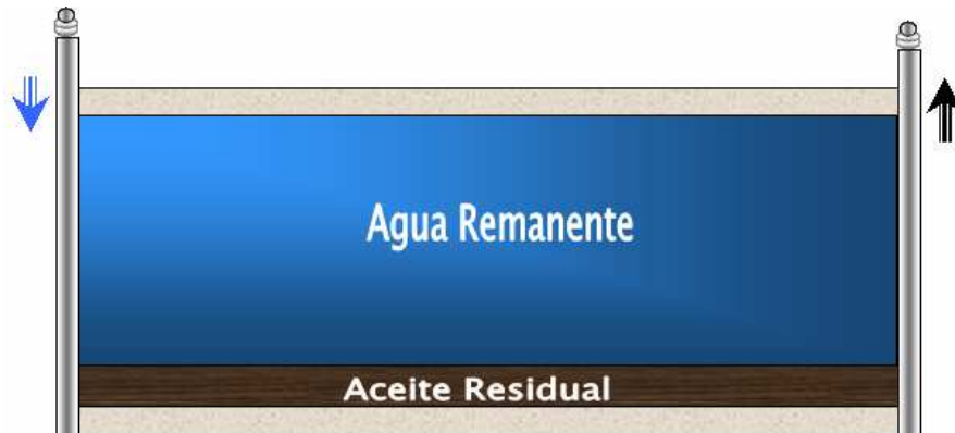
Figura 5: Distribución de los fluidos en el momento del abandono.
