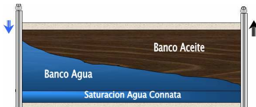
Figura 4: Distribución de los fluidos en el momento de la ruptura.
