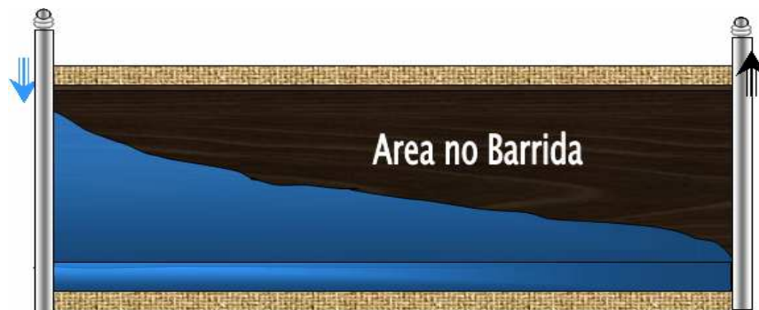
Figura 13: Área no barrida por el agua inyectada, en espaciamientos cortos.
