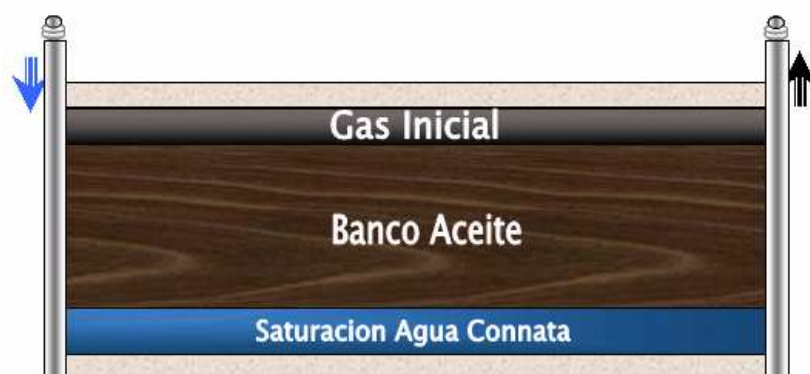
Figura 2: Distribución esquemática de los fluidos antes de la inyección.
