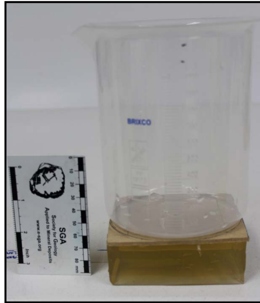
Figura 18. Metodología para medir las propiedades elásticas de la gelatina. a) bloque de gelatina estable. b) bloque de gelatina sometido a un esfuerzo vertical, ejercido mediante el peso del vaso medidor y su contenido de agua.
