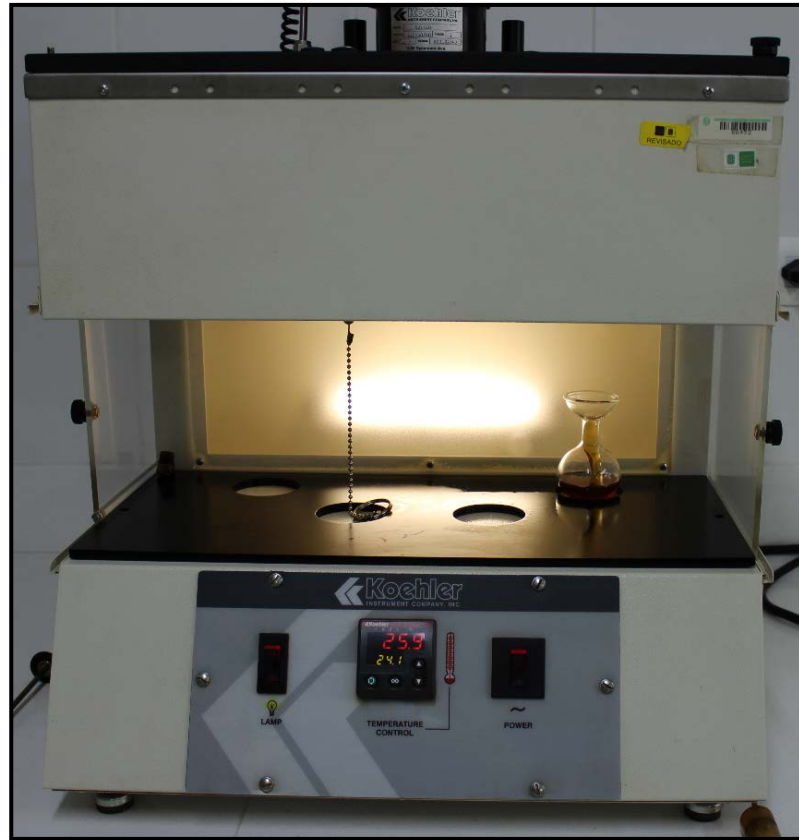
Figura 21. Viscosímetro de Koelher, en proceso de la medición de la muestra de miel.
