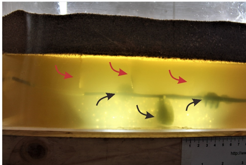
Figura 30. Etapa final del modelo 2, evidencia los cambios de la dirección del fluido al entrar en contacto con las superficies de anisotropía.
