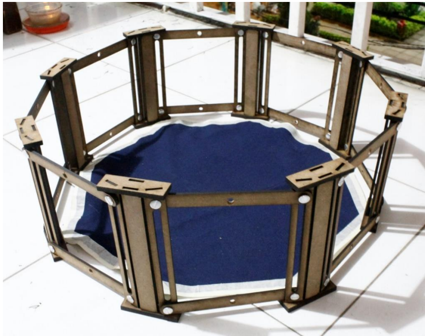
Ilustración 43, Estructura octogonal armada con módulos independientes
