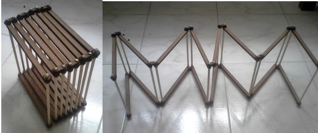
Ilustración 36, Despliegue de estructura basada en el biombo
