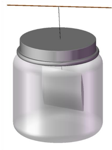
Figura H1. Montaje de absorción para las pruebas de hinchamiento en tolueno puro y soluciones de crudo pesado y liviano.
