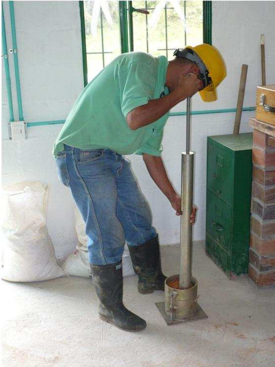
Figura 16, Ensayo de compactación
