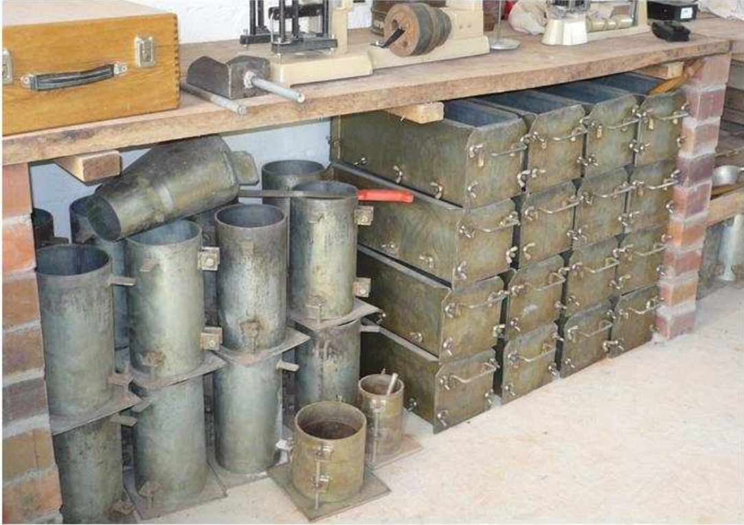
Figura 18, Moldes para cilindros y vigas de concreto
