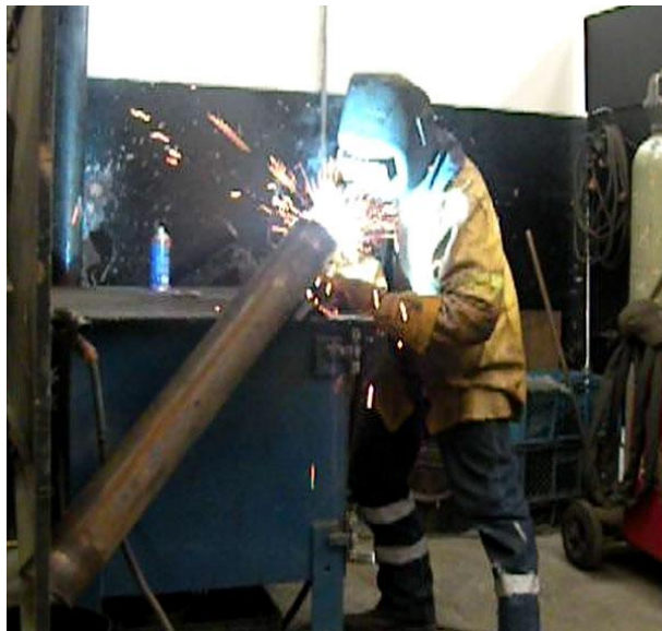
FIGURA 2.1 Acomodación postural para soldadura de rodillos de 40" de largo
