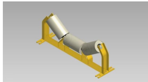
FIGURA 2.3 Estación de Carga
