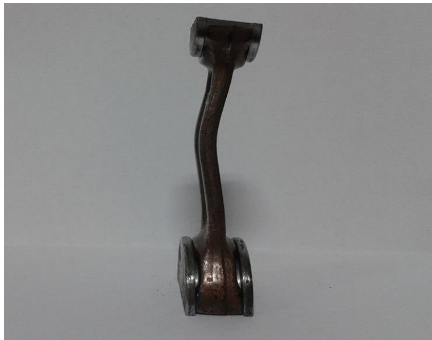
Figura 38. Estado final de la biela luego de aplicar el ensayo de compresión.
