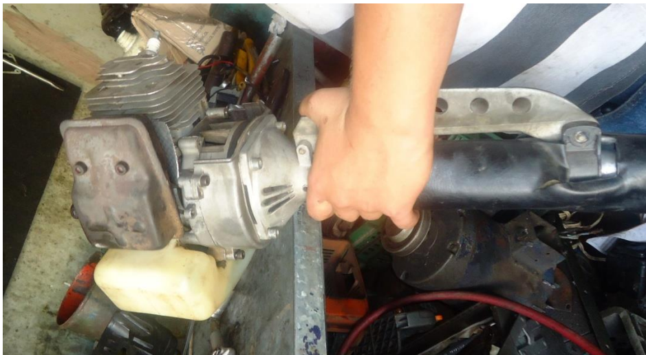
Figura 145. Instalación caña de corte en el motor.
