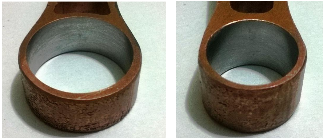
Figura 119. Resultado final rectificación cabeza y pie de biela prototipo.
