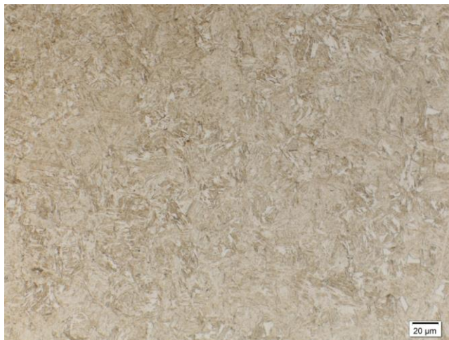
Figura 30. Probeta cabeza biela 500X, ataque NITAL. Borde.
