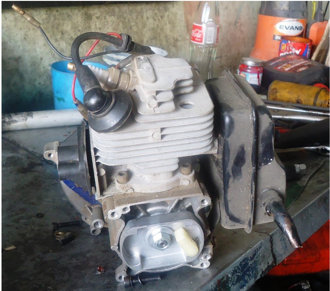
Figura 139. Motor en el que se instaló la biela, sin cubierta.
