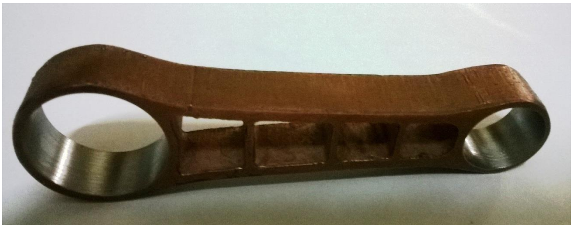
Figura 118. Resultado final rectificación alojamientos biela.
