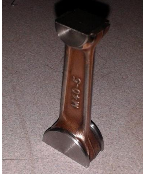
Figura 35. Biela puesta sobre los dos apoyos lista para ensayo de compresión.
