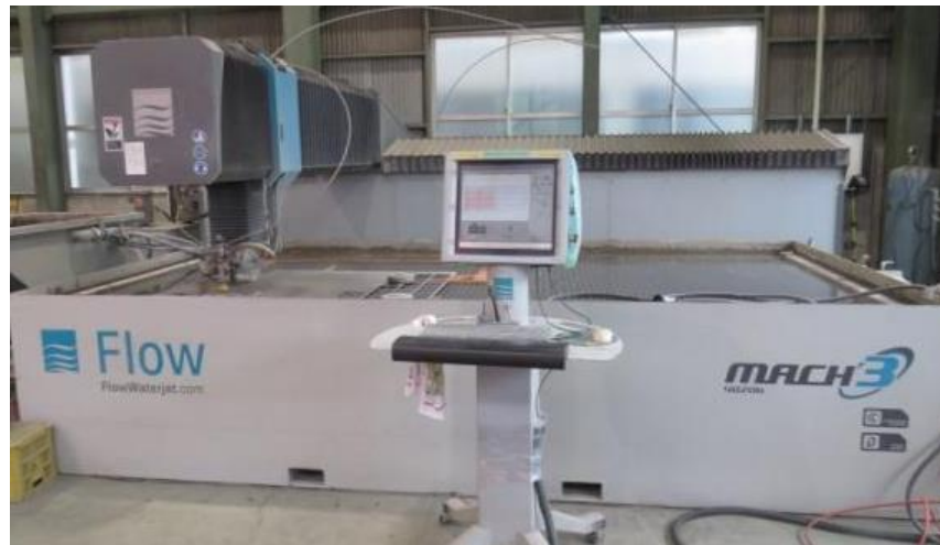
Figura 100. Maquina FLOW MACH 3 de corte en frio por chorro de agua.
