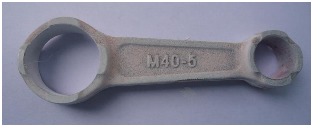
Figura 13. Resultados del ensayo de líquidos o tintas penetrantes sobre la biela.
