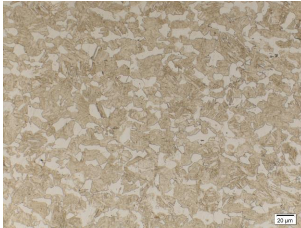
Figura 29. Probeta cabeza biela 500X, ataque NITAL. Centro.
