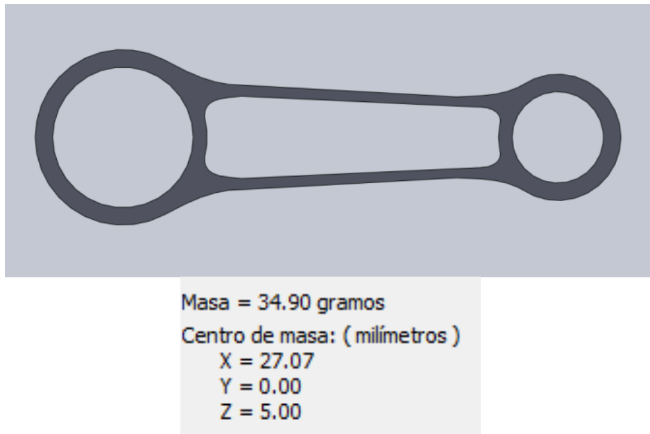
Figura 75. Segunda propuesta de diseño del perfil geométrico biela.
