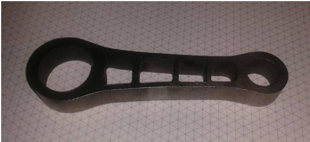
Figura 115. Resultado final cementación y temple localizados.
