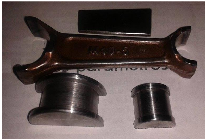
Figura 34. Biela cortada para ensayo de compresión junto con sus dos apoyos.
