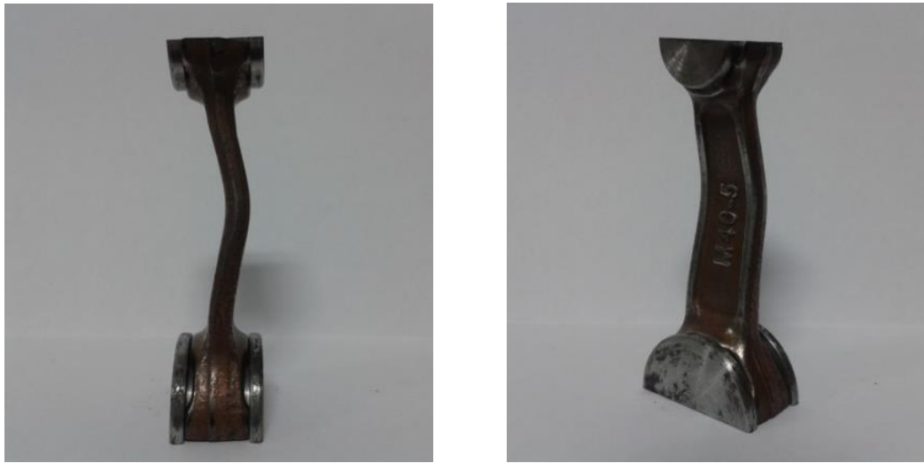
Figura 45. Falla de la biela por pandeo luego de la aplicación de la carga.
