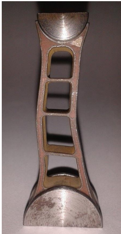
Figura 131. Biela prototipo deformada luego del ensayo de compresión aplicado.
